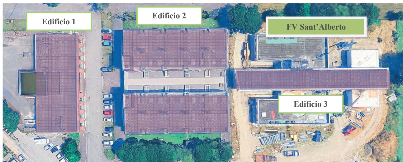
Figura 1 – suddivisione degli impianti in copertura Trattasi di installazione del tipo BAPV (Building Applied Photovoltaic)
